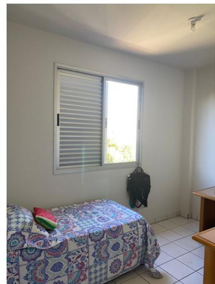
Há um grande desconforto visual no ambiente, provocado pelos níveis de iluminância inadequados. É utilizada apenas uma lâmpada de LED, de 9W, 806lm de cor branca fria 6500K, instalada direto no plafon soquete no centro do forro do quarto.
